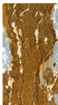
Galvanisation à chaud 20 µm après 6 semaines
