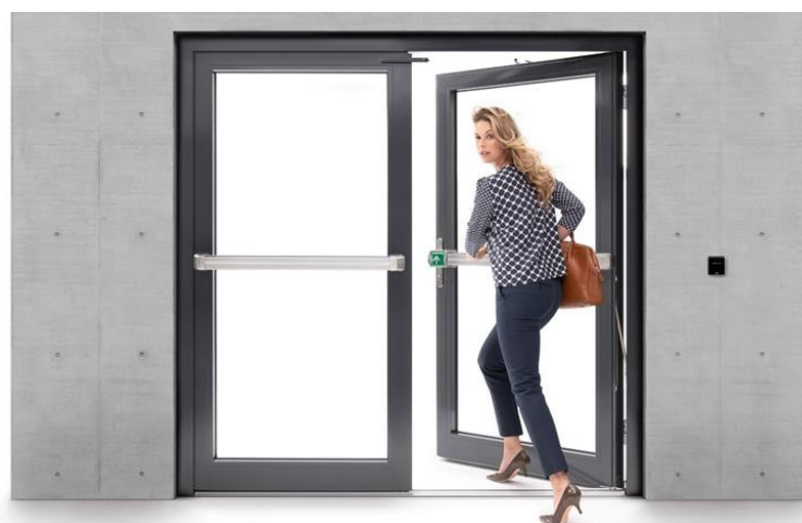
De push- of touchbar wordt gemonteerd op een hoogte tussen 900 en 1100 mm vanaf de afgewerkte vloer
